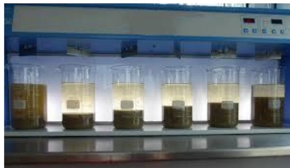
Fig. 1 Coagulation Chimique
