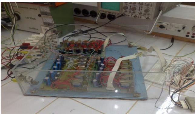
Fig. 12. Photo d'un onduleur solaire à trio niveaux triphasé
