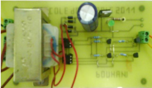
Fig. 11. Photo du circuit de commande d'un IGBT
