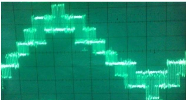
Fig. 17. Tension simple aux bornes de la charge avec  $f_r = 10Hz$  et  $r = 0.86$
