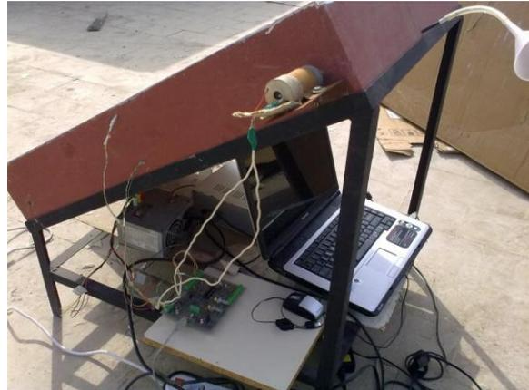
Fig.1.36 Distillateur solaire à bassin incliné et mèche mobile [62]
