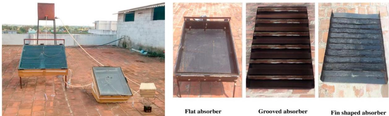
Fig.1.25 Distillateur solaire intégré et les différents plaques absorbeurs de formes différents [51]
