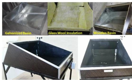
Figure 1.48 Distillateur solaire avec condenseur interne intégré [73]
