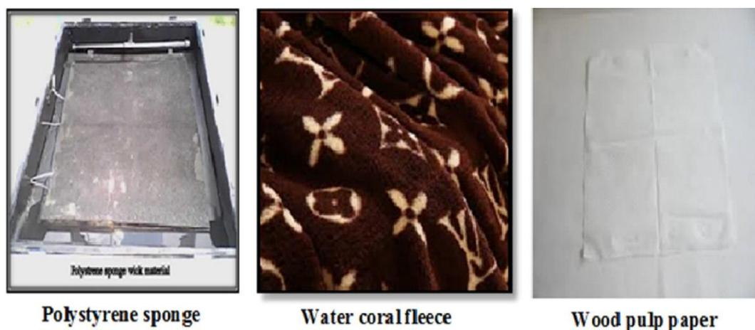
Fig.1.33 Mèches testés sur le distillateur solaire [58]
