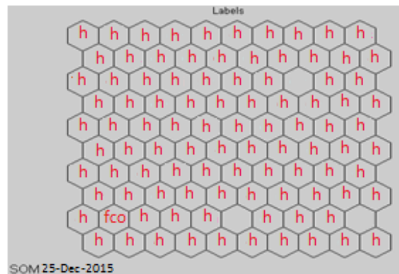
Fig. 9 Fault detection result of the inverter by the SOM map
