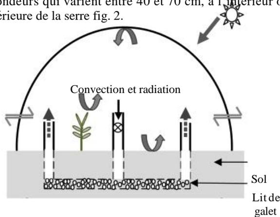
Fig. 2 Stockage dans le lit de galet à l'intérieur de la serre
