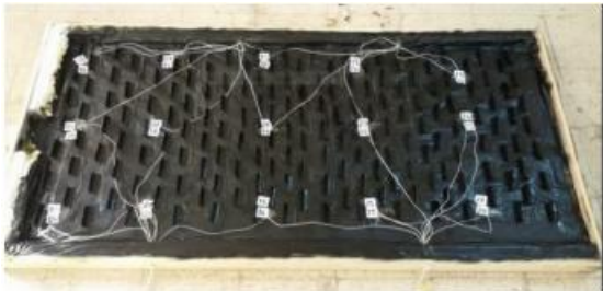
Fig. 2 Emplacements des thermocouples dans l’absorbeur et l’air à l’intérieur du capteur.
