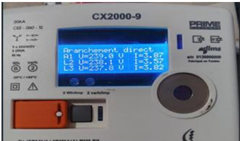
Fig. 3 : Mesure avec le branchement direct du compteur intelligent
