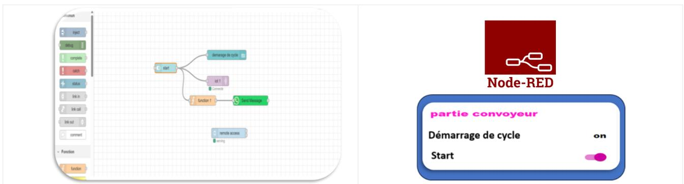
Fig. 7 Interfaces Node -RED (Commande du convoyeur)
