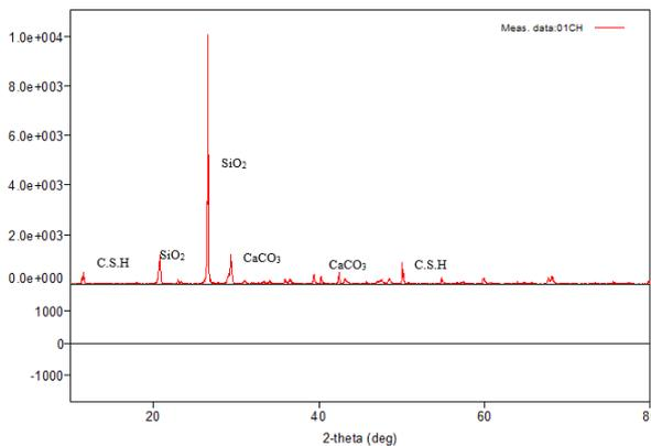
Fig. 4. Analyse DRX de SC6 (100% Ch)
