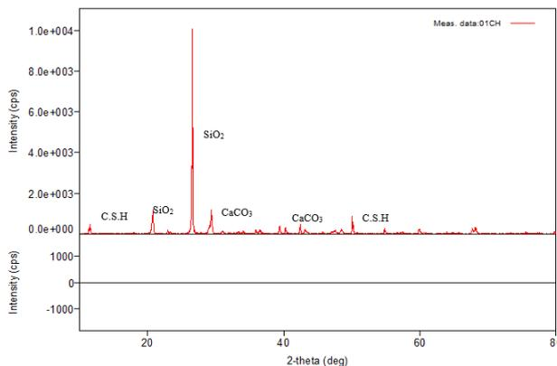
Fig. 2. Analyse DRX de SC1 (50% Ch+50% Pz)
