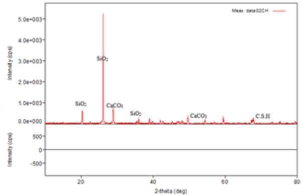
Fig. 3. Analyse DRX de SC2 (20% Ch+80% Pz)
