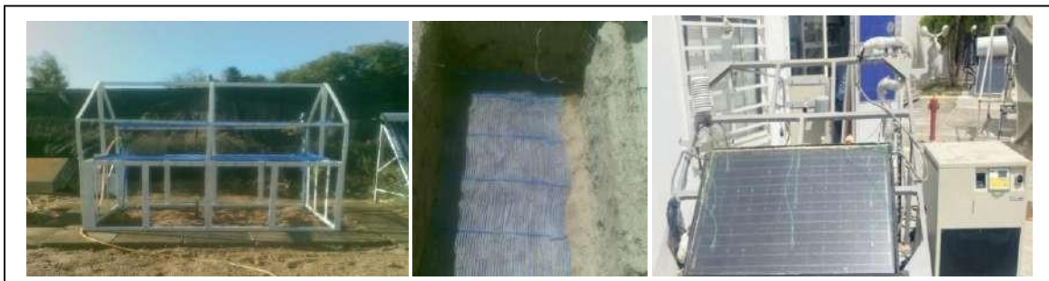
Fig. 1 Photos de la serre avec le système de chauffage (PVT)
