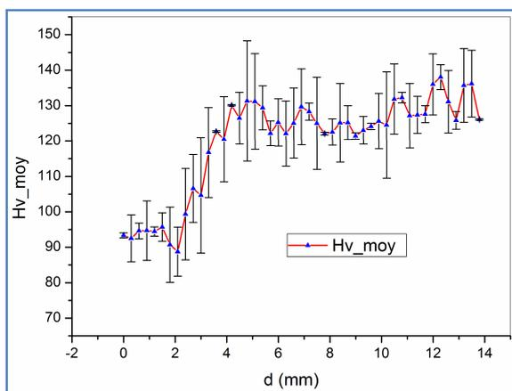
(b) microdureté moyenne des deux profils
