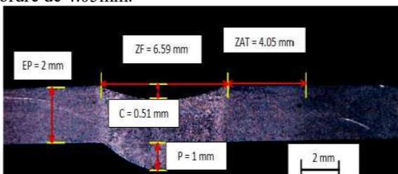
Fig 4 : macrographie des la soudure 3.
