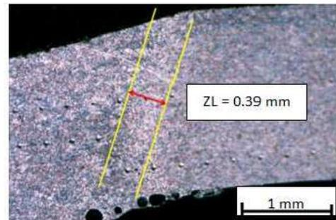
Fig 5 : macrographie des la zone de liaison de la soudure 3
