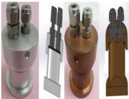
Figure.1 : Photo des réacteurs fabriqués en Cuivre et Aluminium
