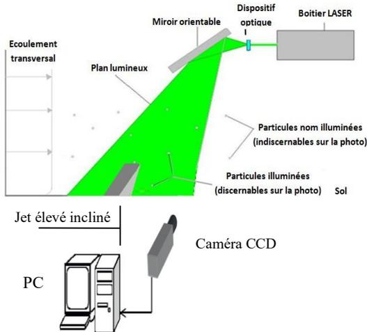
Fig. 1 Dispositif expérimental
