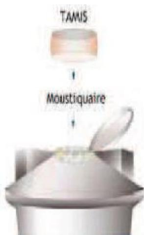
Figure IV-8 : Système de filtration amélioré Source : proposé et testé par la DSDS
