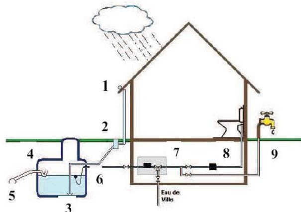
Figure IV-9 : Schéma d'installation type d'un système de récupération d'eau de pluie Source : la Direction Générale de la sante France
