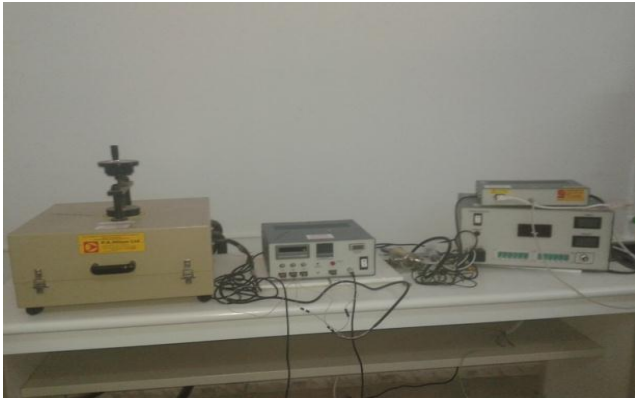
Photo. 2 Dispositif expérimental de mesure de la conductivité thermique (HN112)
