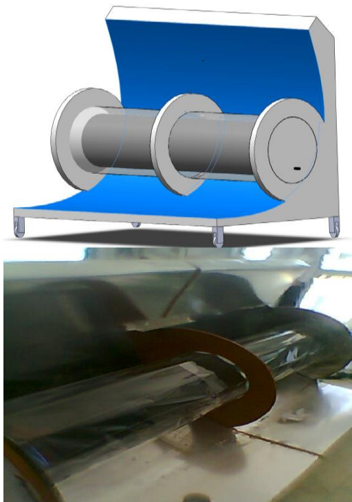
Fig.6. Chauffe-eau solaire cylindro-parabolique CЕСCP
