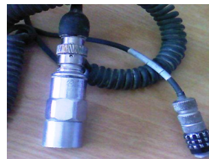
Fig. 1. Accéléromètre de type piézoélectrique
