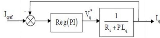
Fig. 1 Commande du courant par un régulateur PI.
