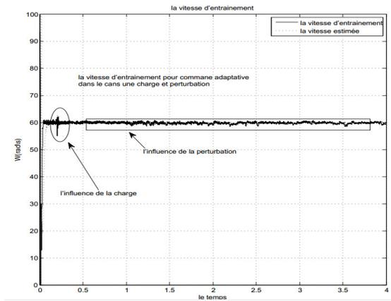
Fig. 14 Variation de la vitesse dans le cas de la présence d'une perturbation et une charge pour une commande adaptative
