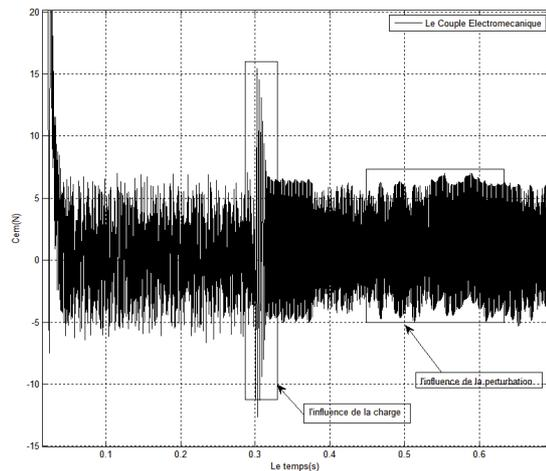
Fig. 16 Couple électromécanique dans le cas d'une d'une charge et perturbation (zoom)
