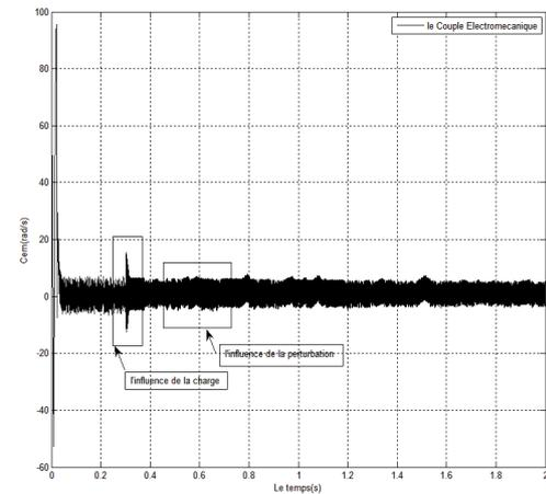
Fig. 15 Couple électromécanique dans le cas d'une d'une charge et une perturbation
