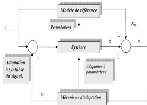
Fig. 3 Structure d'une commande adaptative avec modèle de référence
