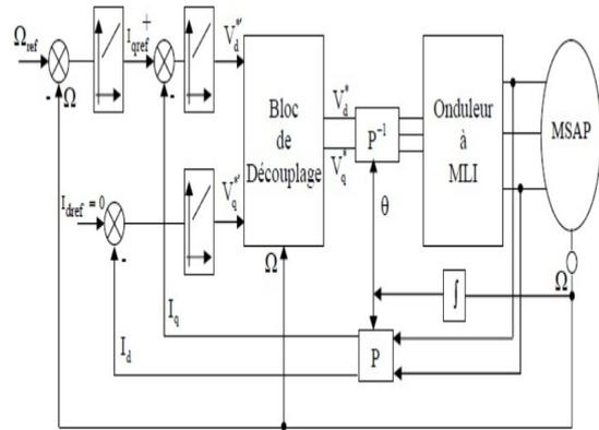
Fig. 2 Structure d'une commande vectorielle d'une MSAP
