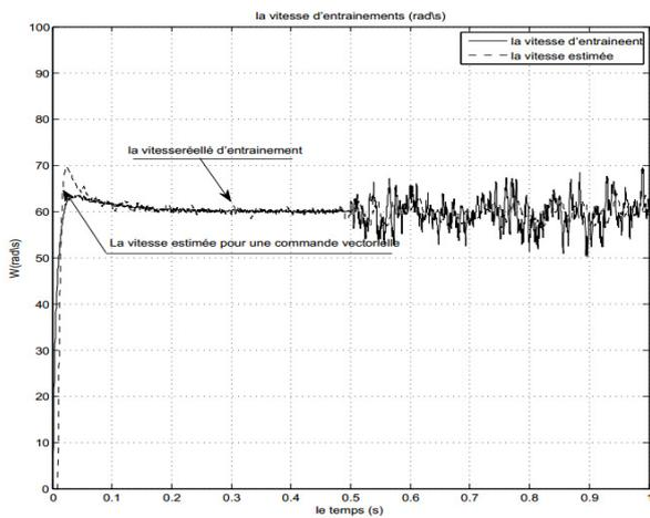
Fig. 7 Variation de la vitesse dans le cas de la présence d'une perturbation
