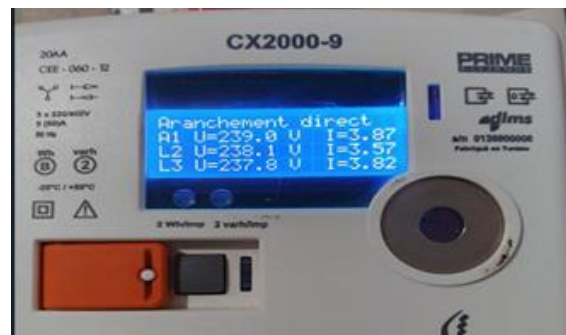
Fig. 3 : Résultats de mesure en branchement direct
