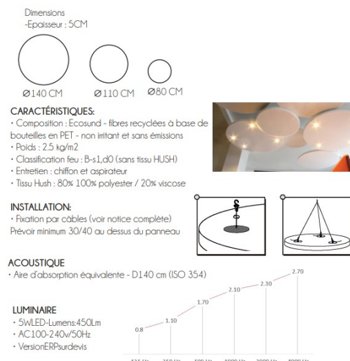
Figure 10 : Exemple de choix architecturaux pour l'espace de concentration (Zone (H) d'observation) nécessitant une isolation phonique et une correction acoustique (à gauche, les caractéristiques du dispositif d'absorption sonore, à droite, l'image de synthèse de l'espace), source : extrait des travaux des étudiants
