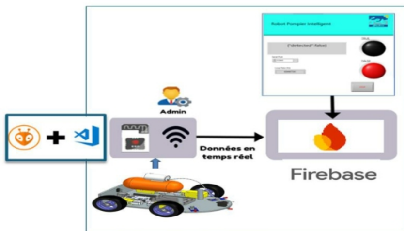
Fig 2 : Architecture IOT du robot
