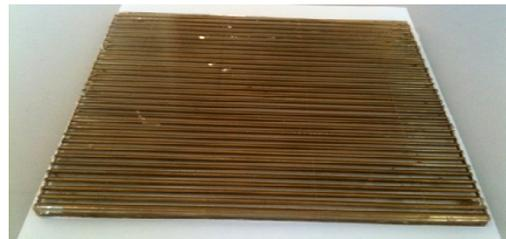
**Figure 4:** Echantillon (II): résine époxy + tubes en cuivre (4 mm de diamètre extérieur et 3.2mm de diamètre intérieur).
