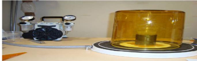
**Figure 2:** Evacuation sous vide des bulles d'air avant l'injection
