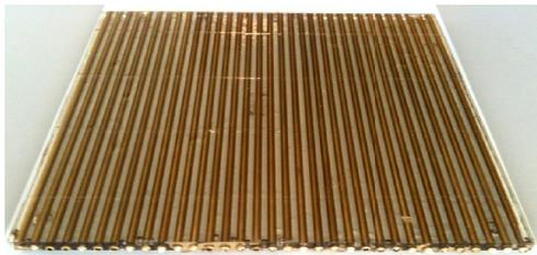
**Figure 3:** Echantillon (I): résine époxy + tubes en Laiton (3.56 mm de diamètre extérieur et 2.74mm de diamètre intérieur).
