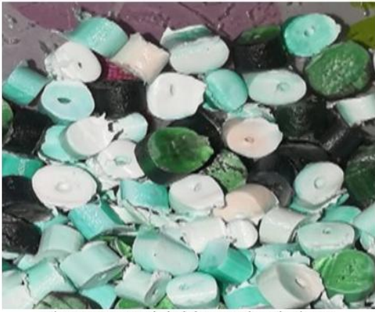
Figure 2 Aspect général des granulats plastiques.
