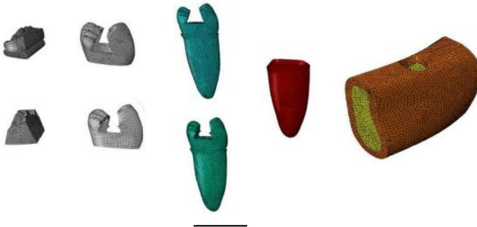
Figure. 5 – Maillage utilisant des éléments linéaires tétraédriques.
