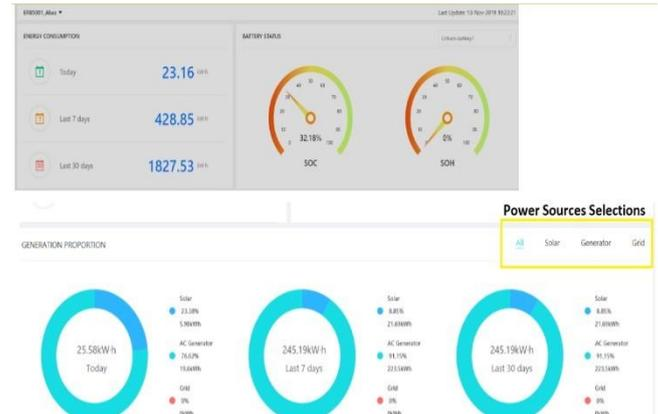
Fig.3 estimation de la consommation d'énergie dans une station de réseau cellulaire isolé
