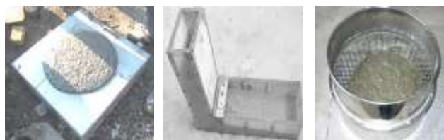
Figure 1 : Essais pour la caractérisation du béton testé à l'état frais
