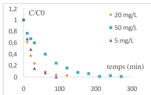
Fig.8. Évolution temporelle de la concentration réduite du tubatin pour différentes concentration initiales en polluant (Q=50 ml/s, pH=6,5)
