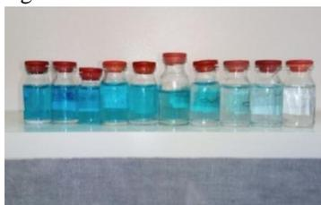
Fig.2. Décoloration temporelle du colorant au cours de la photodégradation.
