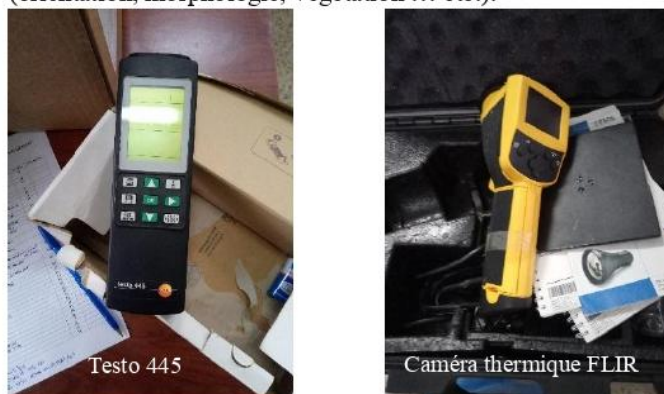
Figure 3: Instruments de mesures ponctuelles ayant servi pour les campagnes de mesures sur le site d'étude
