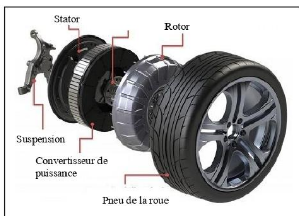
Fig. 1 Technologie du Moteur-Roue du véhicule électrique
