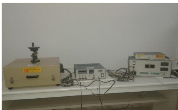
Photo. 2 Dispositif expérimental de mesure de la conductivité thermique (HN112)
