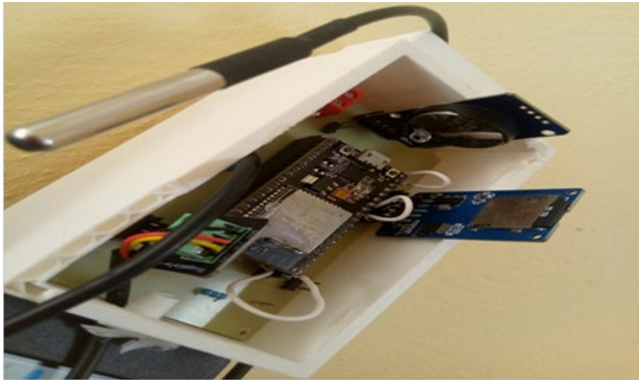
Fig. 3 IoT module prototype
