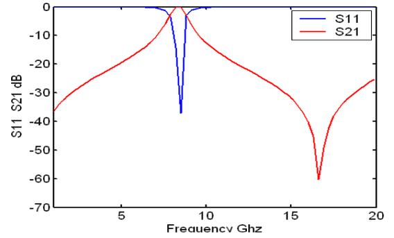
Fig.3 Scattering parameters S11 and S21
